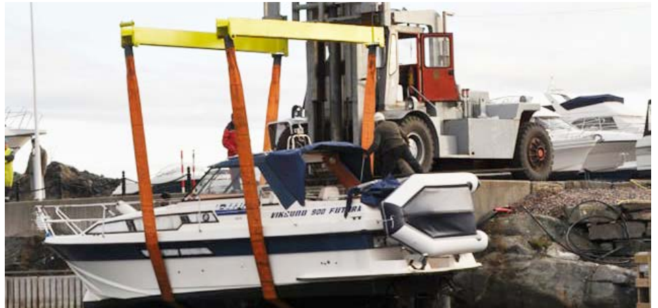
KLEPPES UTSETTINGSTRUCK kan sette ut båter opp til 12 tonn. Den har egen garasje med verksted og kontor i andre etasje.
